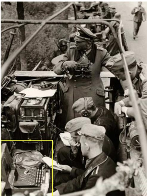
*Véhicule de commandement de la Wehrmacht avec ses moyens de transmissions et une machine Enigma (encadrée)*
